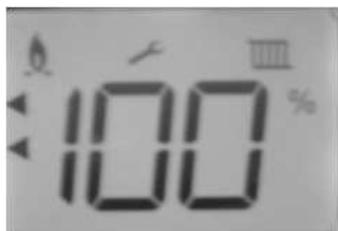
На экране отразится значение показывающее температуру подачи отопления и знак ключа. Если после этого нажать на кнопку ИНФО, можно увидеть и значения вентилятора.
