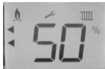
Нажмите на info. При нажатии на кнопку info на экране высветится мощность вентилятора в %. Данное значение обычно понижается до %50 автоматически.
