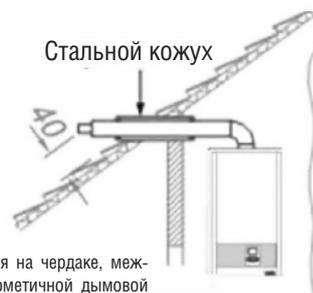
Если котел будет устанавливаться на чердаке, между кровельным покрытием и герметичной дымовой трубой следует установить негорючий материал или стальной кожух. Расстояние между выходом отходящих газов и уклоном крыши должно быть 400 мм.
